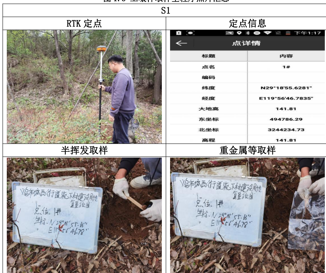
图 1.3 土壤样取样全程序照片汇总
