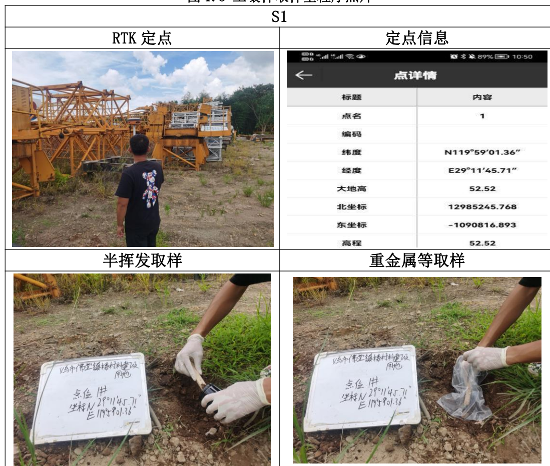
图 1.3 土壤样取样全程序照片
